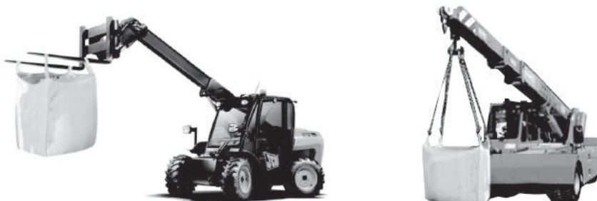
Рисунок 9 Способы перемещения наполненного контейнера КБД «Шанс».
