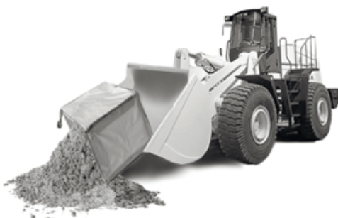
Рисунок 10 Рекомендуемые способы демонтажа контейнеров КБД «Шанс».
